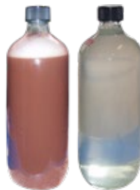
Aspect des eaux usées avant et après prétraitement
