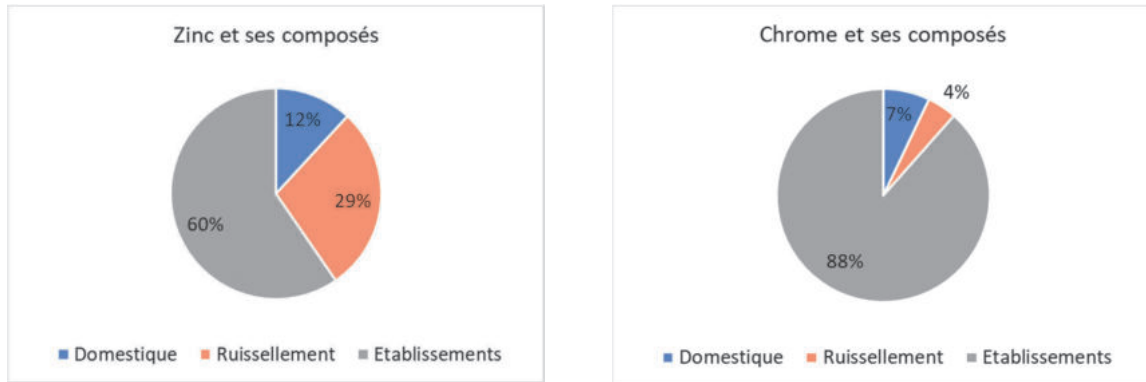
Figure 16 : Contribution des différents types des sources d'émission au flux de Zn et de Cr en entrée de la STEU.
