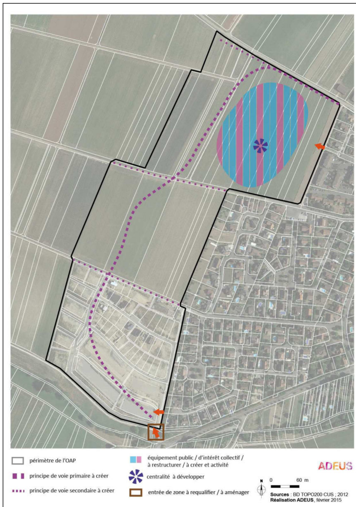
Carte n°1 : Schéma de principes - organisation viaire et centralité du secteur d'extension Ouest
