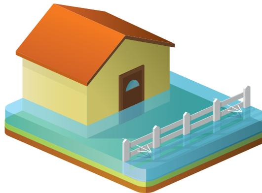
Figure n°4 : Exemple de clôture assurant la transparence hydraulique.
