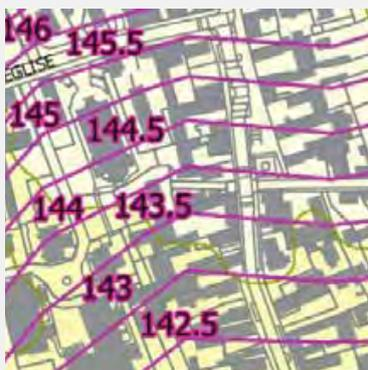
Figure n°8 : Extrait du plan de zonage réglementaire B « Zones de remontée de la nappe phréatique »
